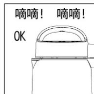
机器按设定程序完成制浆后，发出“滴滴、滴滴”的声音，提示豆浆已完成，同时该功能指示灯闪烁，此时请拔下电源插头，准备饮用。
