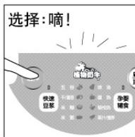
触摸“选择”键选择对应的功能，每次选择后，仅对应功能指示灯（或图形指示灯）亮并闪烁，并伴有“嘀”一声提示音，触摸“启动/取消”键启动功能，机器伴有“滴滴”提示音提示已启动。
