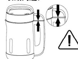
■ 加水至上下水位刻度线之间。制作米糊时，加水至上水位刻度线处。
