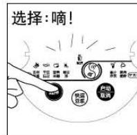
按“选择”键选择相应功能程序，对应功能指示灯（或图形指示灯）亮并闪烁，按“启动/取消”键启动制作程序，机器伴有“滴滴”两声提示音，提示程序已启动。
