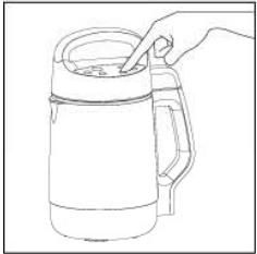
请将机头按正确的位置放入杯体中，插上电源线，指示灯全亮，按果蔬冷饮功能键，这时果蔬冷饮功能对应图形指示灯亮，同时启动该功能程序。
