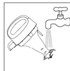
2. 超微精磨器：请用清洗刷仔细清洗超微精磨器，注意一定要用清水冲洗干净，以免残留豆浆产生异味。
