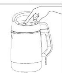
请将机头按正确的位置放入杯体中，插上电源线，指示灯全亮，按“好豆浆”键，选择相应功能程序，当选择的功能对应图形指示灯亮时，机器将自动启动相应的豆浆制作程序。
