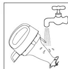
1. 机头：请用水轻轻洗去机头下部粘附的豆浆或其他东西，切勿将机头浸入水中，也不要用水清洗机头上部，以防止机头进水，发生短路现象。
