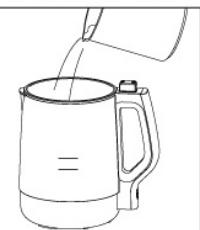
请将水加至上、下水位刻度线之间。（本机具有无水防干烧功能，如杯体内无水或水位过低，机器不会工作，以保证使用安全。）
