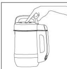
请将机头按正确的位置放入杯体中，插上电源线，指示灯全亮，按“好豆浆”或“果蔬浓汤”键，选择相应的功能程序，当选择的功能对应图形指示灯亮时，然后再按启动键机器将自动启动相应的豆浆制作程序。
