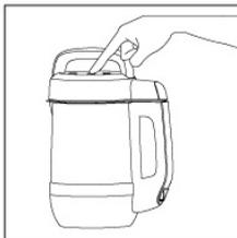
请将机头按正确的位置放入杯体中，插上电源线，指示灯全亮，按“果蔬浓汤”键选择“果汁”功能，再按“启动”键启动该程序。
