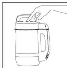
请将机头按正确的位置放入杯体中，插上电源线，指示灯全亮，选择相应功能键，这时被选择功能对应图形指示灯亮，按下“启动”键启动相应功能程序。
