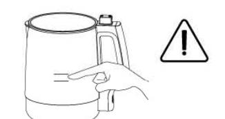
1. 机头、耦合器、底座、电源插座请勿进水，如果进水，必须擦干后才能使用。
