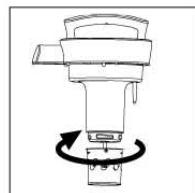
请将五谷精磨器按照安装指示箭头方向装好，五谷精磨器口部与下盖配合处应紧密无缝隙，安装完毕后，用手向下拉一下，五谷精磨器不动，说明安装到位。
