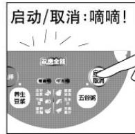
若此时还未开始打浆，请拔下电源线，等待3-5分钟后插上电源线，选择正确的功能程序来工作，若已开始打浆，建议更换物料，重新开始制浆操作。
