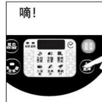
触按“选择”键选择功能，对应的功能指示灯闪烁，并伴有“嘀”一声，触按“启动/取消”发出“嘀嘀”启动功能，同时数码屏动态显示。
