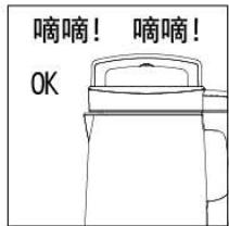
制浆完成时，功能指示灯闪烁，并发出“滴滴…滴滴…”声，同时数码屏显示“End”，可断电准备制作豆花。
