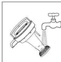
**2 清洗破壁精磨器：**请用清洁刷仔细清洗破壁精磨器，注意一定要用清水冲洗干净，以免残留饮品残渣产生异味。
