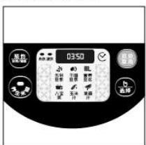
启动预约后，功能指示灯及所选温度指示灯常亮，数码屏显示倒计时。
