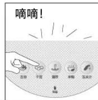
按相应的功能按键选择相应功能程序，每次选择，机器都伴有“滴滴”两声提示音，对应功能指示灯常亮，提示程序已启动。
