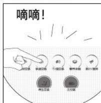
触摸相应功能选择按键选择对应的功能，对应功能指示灯（或图形指示灯）亮并闪烁，并伴有“嘀”一声提示音，3秒钟后机器自动启动，并伴有“滴滴”两声提示音提示已启动。
