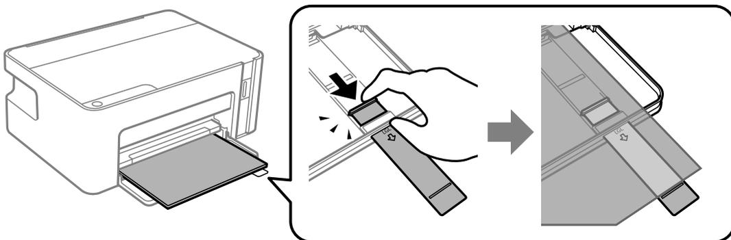
4. 滑动侧导轨，使其靠着打印纸的边缘。
