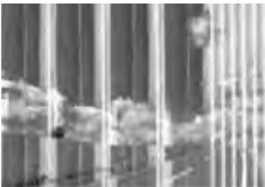
打印头喷嘴可能堵塞。执行喷嘴检查，以检查打印头喷嘴是否堵塞。如果有任何打印头喷嘴堵塞，请清洗打印头。
