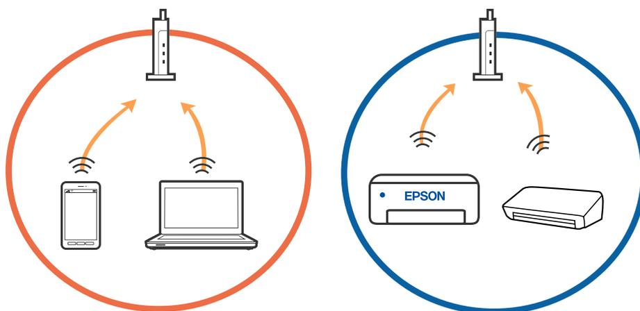
❑ 如果某个无线路由器有多个 SSID，而这些设备连接到该无线路由器上的不同 SSID，则可能无法连接到该无线路由器。将计算机或智能设备与本产品连接至同一个 SSID。
