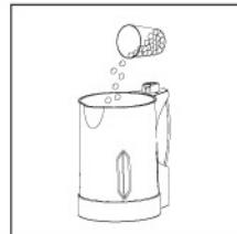
请将量取好的食材或浸泡好的豆子，清洗干净后，放入杯体内。
