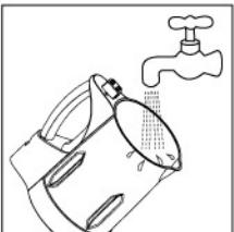
2. 杯体：请用清洁块仔细清洗杯体，将杯体底部以及侧面清洗干净，以免残留的豆浆产生异味，切勿将杯体浸入水中，也不要用水清洗杯体下部，以防止手柄上的插座进水和杯体底部的电热盘进水，发生短路现象。
