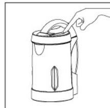
请将机头按正确的位罝放入杯体中，插上电源线，显示屏全亮，按“选择”键选择对应功能，这时被选择功能对应“ $\Delta$ ”型指示灯亮，再按“确定”键，显示屏显示“加热”，启动相应功能程序。
