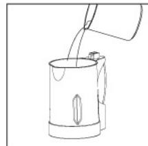
请将水加至上、下水位线之间。（本机具有无水防干烧功能，如杯体内无水或水位过低，机器不会工作，以保证使用安全。）
