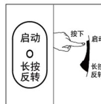
6.插上电源线插头，按下“启动”键，即可启动机器。如需中途停止，按一下“长按反转”键然后松开即可。
