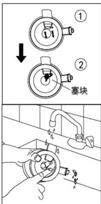
7.)清洗出渣口：拨开集汁盘底部的硅胶塞块，用水冲洗出渣口。
