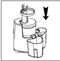
7.将食材清洗干净，切成能送入进料口的小块放入进料口，螺杆会自动将食材切碎，如遇食材卡在进料筒里请用推料棒轻缓推压食材，以食材刚好能被切断为宜。如果榨汁过程中遇到大块食材卡在螺杆的第一道螺纹间打转挤不下去，按住“长按反转”键，将螺杆反转一下，再次启动产品，即可轻松解决。
