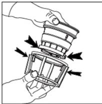
1.将壁刷上的两硅胶片对准挤汁器底部的两处圆弧状缺口，然后将壁刷装配在挤汁器上。
