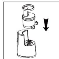
5.将装配好的榨汁组件向下装配在主体上。装配时需要将上盖上的“▲”对准主体顶部的“▲”，如果装不下去，将榨汁组件向左右两侧转动几下，即可装配的到位。
