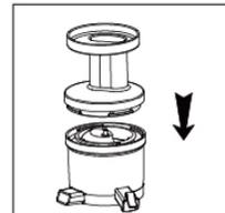
4.将上盖旋入集汁盘上，使上盖的“▼”对准集汁盘的“▲”；顺时针旋转上盖，使上盖的“◀”对准集汁盘的“▲”，上盖即安装到位。如果上盖未旋到位，产品将无法通电工作。
