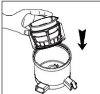
2.将安装好壁刷的挤汁器装入集汁盘内。注意：安装时请将挤汁器上的“▼”对准集汁盘上的“▲”，挤汁器底部的出渣口对准集汁盘底部的出渣口，这样才能安装到位，如果未安装到位上盖将无法盖上。
