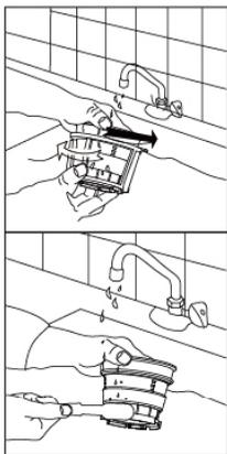
6)先使用壁刷来回旋转清洗挤汁器，若未清洗干净再用清洁刷清洗挤汁器，最后用清水冲洗干净。其余可拆卸部件清洗方法简单，可用清水冲洗，或者用清洁布清洗。
