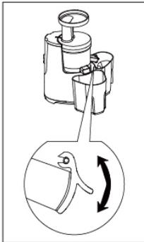
8.当食材加工完毕，出汁嘴不再有汁液流出时，按下“长按反转”键后再松开，断开电源，待电机和螺杆完全停止转动后，再将接汁杯和果渣桶拿出出汁嘴和出渣口。
