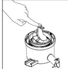
4. 将螺杆放入挤汁器内并下压安装到位。将螺杆轻微转动几下，即可装配到位。
