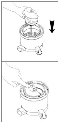
4. 将螺杆放入挤汁器内并下压安装到位。如果未安装到位上盖将无法盖上。
