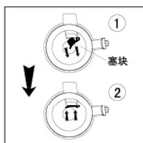
3. 集汁盘底部设有一硅胶塞块。产品使用前请确认塞块是否如图②安装到位。榨汁过程中若未安装塞块将影响出汁和出渣效果。清洗时需拉开塞块以便于清洗出渣口。
