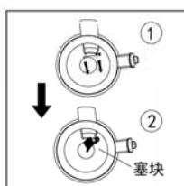
7)拔开集汁盘底部的硅胶塞块，用水冲洗出渣口。
