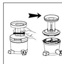
2)逆时针旋转上盖，使上盖的“▼”对准集汁盘的“▲”，即可打开上盖。
