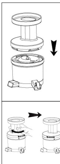
5. 将上盖旋入集汁盘上，使上盖的“▼”对准集汁盘的“▲”；顺时针旋转，当上盖的“▼”对准“▲”时，上盖安装到位。如果上盖未旋到位，产品无法工作。
