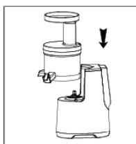
6. 将装配好的榨汁组件向下装配在主体上，使上盖的“▶”对准主体上的“◀”。左右转动几下，更易安装到位。
