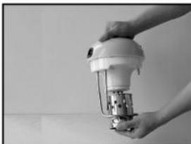
取拉法尔网按安装指示箭头方向装好，拉法尔网口部与机头配合处应紧密无缝隙，安装完毕后，用手向下拉一下，拉法尔网不动，说明安装到位。
