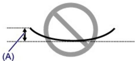
1. 如下图所示，向纸张卷曲的相反方向卷起纸张。
