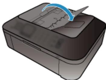
2. 将文档放置在自动输稿器上，然后调整文档导片至文档宽度。
