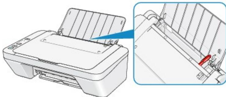
如果后端托盘中存在任何异物，请务必关闭本机，从电源插座拔出打印机插头，然后取出异物。
