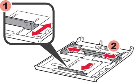
将右侧纸张导片滑至最右端。左侧和右侧纸张导片同时移动。
