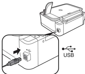
出现**打印机连接**屏幕时, 将 USB 电缆线一端连接到计算机, 另一端连接到本机, 然后开启本机。
