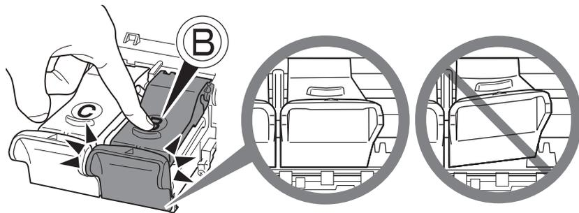
向下推动 (B) 直到听到咔嚓声以使墨盒锁定盖 (B) 完全地关闭。
