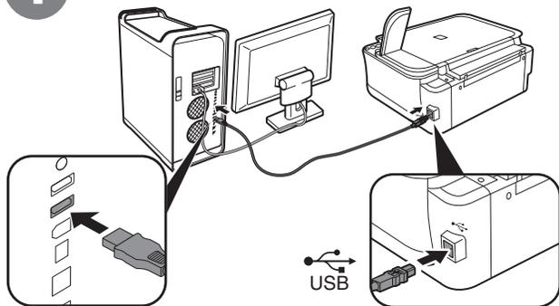
将 USB 电缆线一端连接到计算机并将另一端连接到本机。
