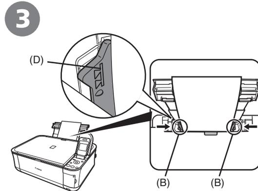
滑动左右纸张导片 (B) 使其紧贴纸张两侧。请勿超出装入限量标记 (D)。
