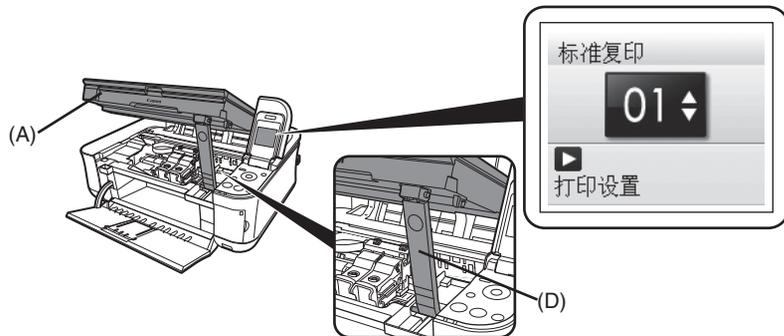
轻轻地抬起扫描单元 (机盖)(A) 并折叠扫描单元支架 (D)，然后轻轻地关闭扫描单元 (机盖)(A)。
