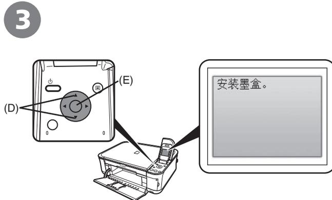
使用操作面板上的 **▲** 或 **▼** 按钮 (D) 选择液晶显示屏上显示的语言，然后按 **OK** 按钮 (E)。显示待机屏幕。
