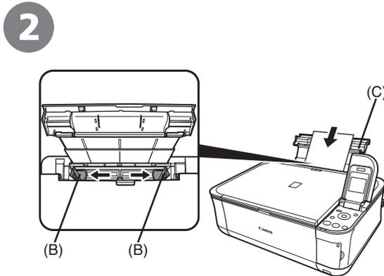
移动纸张导片 (B) 到两端边缘，并将纸张装入后端托盘 (C) 的中部。
