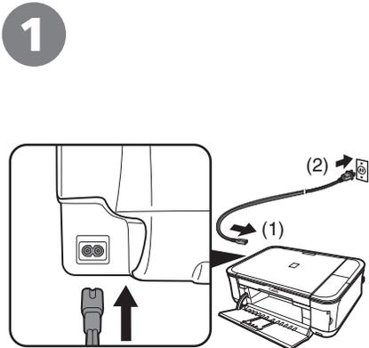
把电源线一端插入本机的左侧并将另一端连接至壁装电源插座上。
