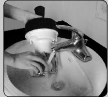
① 机头：请用水仔细洗净机头下部粘附的豆浆等残渣。切勿将机头浸入水中，也不要用水清洗机头上部，以防止机头进水，发生短路现象。
