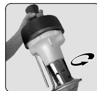
把 V 形聚流精磨器按照精磨器上指示方向装上并旋紧，精磨器口部与下盖配合处应紧密无缝隙，安装完毕后，用手向下拉一下，精磨器不动，说明安装到位。
