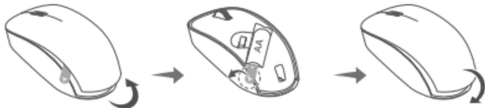
鼠标出厂内置了一节 AA 电池，使用之前，请沿尾部扣手位打开上壳，取出电池后移除隔电挡片，再装回电池并合上上壳。
