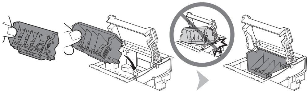
如图所示，向前倾斜打印头并将其安装到适当的位置。
