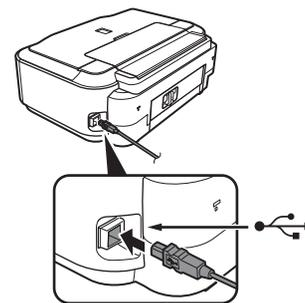
**打印机连接**屏幕出现时，使用USB电缆线将打印机连接到计算机。连接电缆线后，开启打印机。
