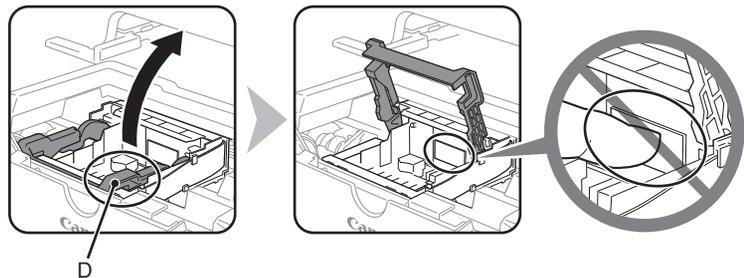
稳固地抬起打印头固定器的打印头锁定杆的(D)部分直到其停止。
