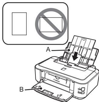
将4"×6"(10×15厘米)的照片纸打印面向上纵向装入后端托盘(A)。(有关详细资料, 请参阅第16页。)
