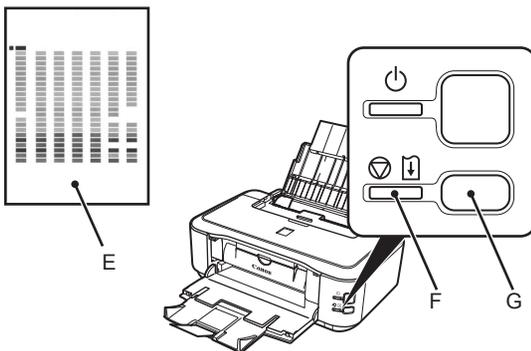
打印完所示的蓝色和黑色图案(E)时, 打印头对齐完成。
