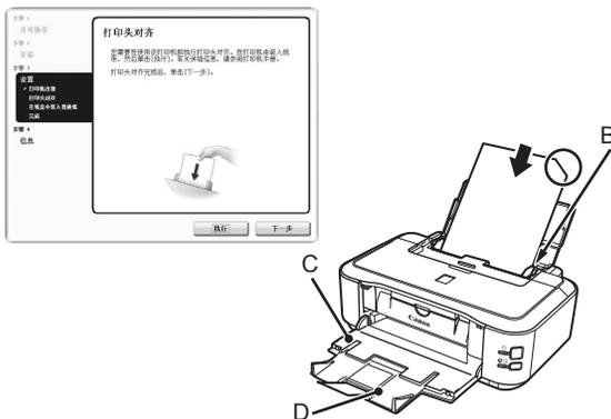
在后端托盘(B)中装入一张附带的打印头对齐专业纸张(无光泽照片纸MP-101), 并单击**执行**。有关详细资料, 请参阅第16页的“5 装入纸张”中的③。
