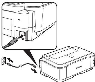
将电源线稳固地插入打印机上的电源线连接器，并稳固地连接到壁装电源插座上。
