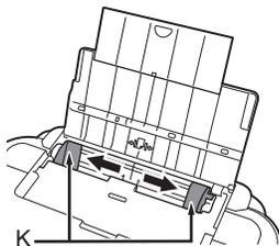
移动纸张导片(K)到两侧边缘。
