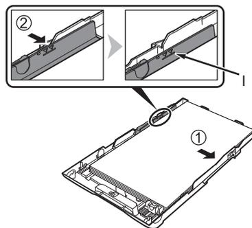
将纸张与纸盒的右侧(1)对齐，并滑动左纸张导片使其紧靠纸张左侧边缘(2)。
