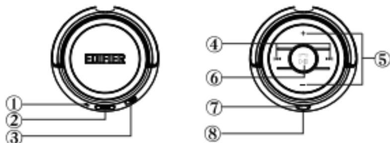
① 电源指示灯                      ② 充电接口                      ③ 电源开关
