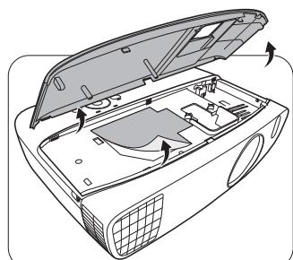
5. 在安装时断开灯泡接口与投影机的连接。
