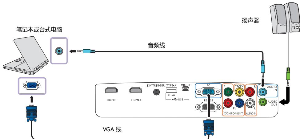
许多笔记本电脑在连接到投影机时并未打开其外接视频端口。通常，组合键如 Fn + F3 或 CRT/LCD 键可打开 / 关闭外接显示器，在笔记本电脑上找到标示 CRT/LCD 的功能键或带显示器符号的功能键。然后同时按下 Fn 和标示的功能键，有关笔记本电脑的组合键信息，请参见笔记本电脑的说明文件。
