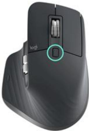
默认设置下，模式切换功能被分配给鼠标顶部的按钮。如果您希望停留在单个滚动模式下并手动切换，请使用 **Logitech Options** 软件禁用智能切换。您还可以调整智能切换的灵敏度，这将改变自动切换至自由滚动所需的滚动速度。
