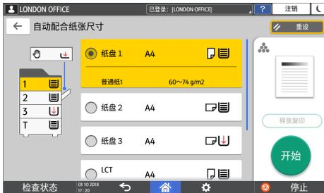
当原稿的方向与纸盘中纸张的方向不一致时，机器会自动旋转复印的图像。例如，若要将 A3 (11 × 17) 尺寸的原稿缩小到 A4 (8<sup>1</sup>/<sub>2</sub> × 11) 尺寸，可以选择 A4 (8<sup>1</sup>/<sub>2</sub> × 11) □或 A4 (8<sup>1</sup>/<sub>2</sub> × 11) □。
