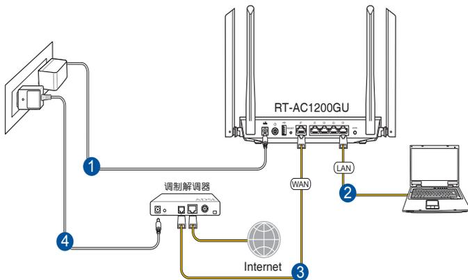
无线连接：用一根网线（2）连接调制解调器与路由器上的蓝色以太网接口。开启电脑或其他设备的 Wi-Fi 功能。
