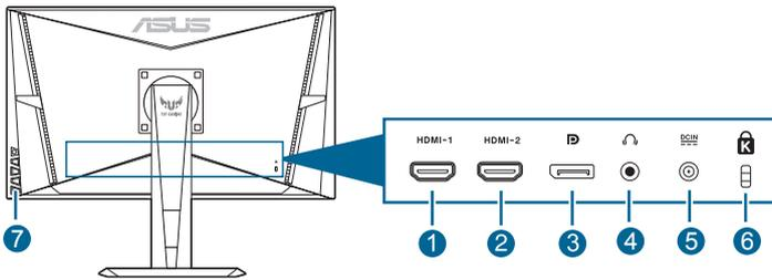
1. **HDMI 端口。** 此端口用于连接 HDMI 兼容设备。
