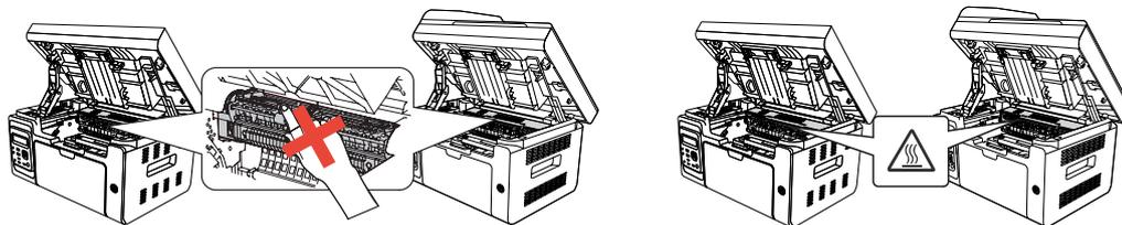
**注：** • 取下激光碳粉盒时，请将激光碳粉盒装入保护袋或用厚纸包裹，避免光线照射而损坏感光鼓。
