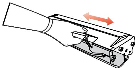
5. 取下激光碳粉盒保护罩（吸塑罩），将激光碳粉盒沿着导轨放入打印机，沿着箭头方向按压直至听到“咔嚓”声音后，完成安装。
