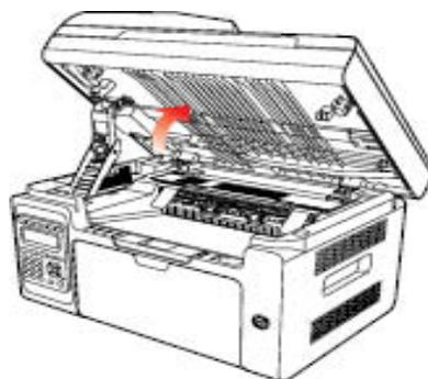
2) 利用凹入部分上方突起，打开出纸槽。
