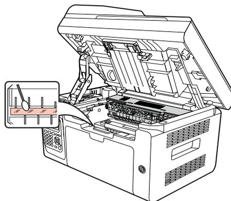
8. 清洁打印机内部，如下图所示，用干燥无绒软布轻轻拭擦下面阴影处。
