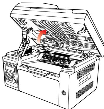
5. 利用凹入部分右上方突起打开出纸槽。
