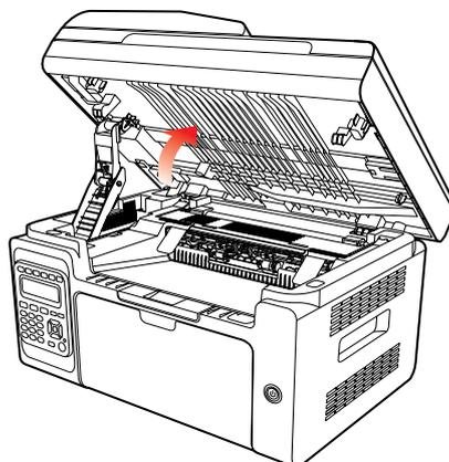
2. 利用凹入部分右上方突起打开出纸槽。
