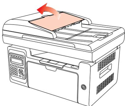
2) 将原稿以正面向上、顶部先进入的方式放入自动输稿器 / 文档进纸器中。
