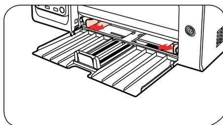
c) 抬起出纸托盘，避免纸张滑落。
