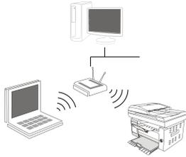
基础结构模式：通过路由器与无线设备连接
