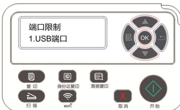
4. 按方向键“▲”或“▼”选择“关闭/开启”，按“OK”键，显示“\*”表示选中该项，USB端口设定完成。
