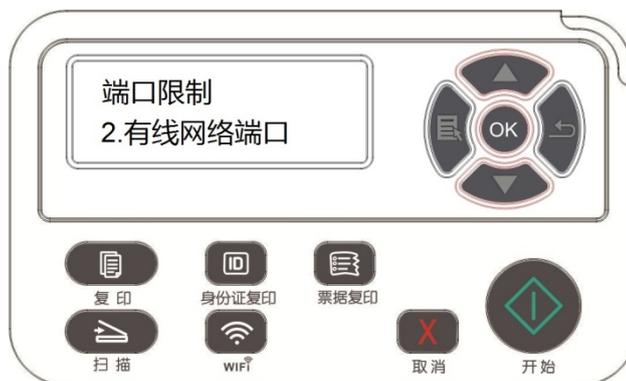
4. 按方向键“▲”或“▼”选择“关闭/开启”，按“OK”键，显示“\*”表示选中该项，有线网络端口设定完成。
