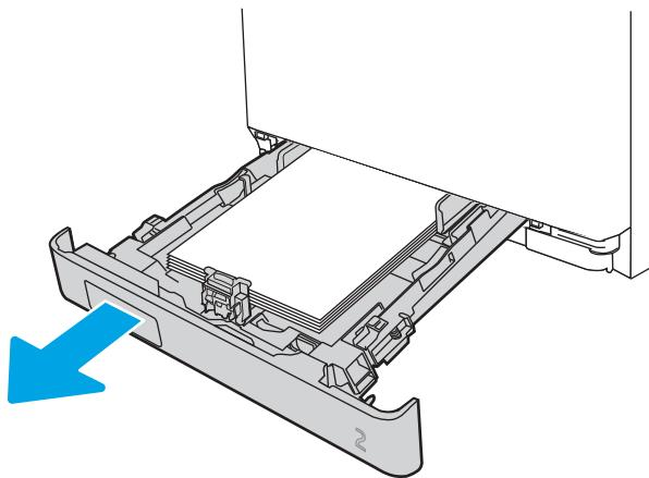
3. 在纸盘 2 腔室左侧, 按下压片以压低纸盘支承板, 然后取出所有纸张。轻轻平直拉出卡塞的纸张。
