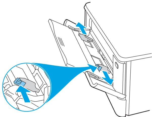
4. 将纸张装入纸盘。确保纸张位于卡子下面并且低于最大高度指示器。
