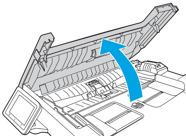
2. 使用蘸水的无绒布擦拭拾纸轮和分隔垫，以消除灰尘。
