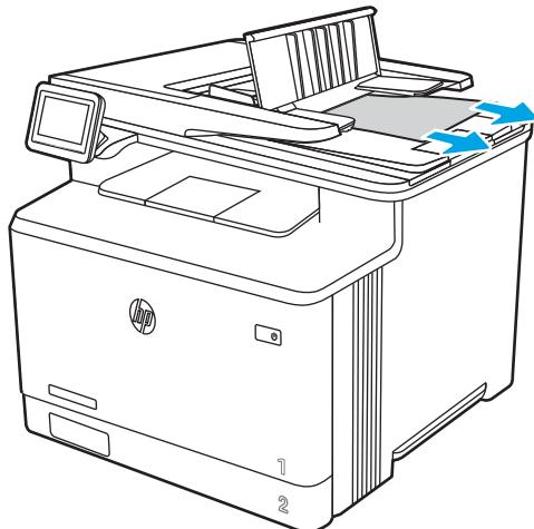
5. 打开扫描仪盖板。如果纸张卡在白色塑料底板后面，请轻轻拉出纸张。
