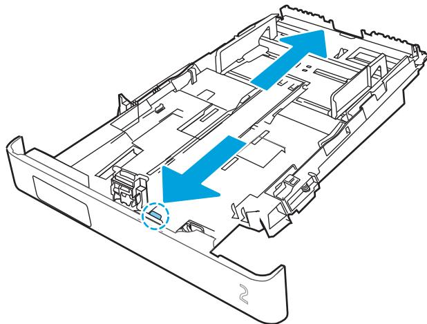
**注:** 装入 Legal 尺寸纸张时, 纸盘 2 将从打印机前部伸出约 51 毫米。
