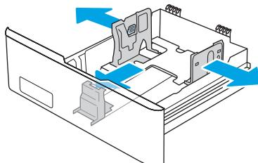
3. 要装入 Legal 尺寸纸张，在挤压前部栓锁的同时拉动纸盘前部，即可延伸纸盘前部。
