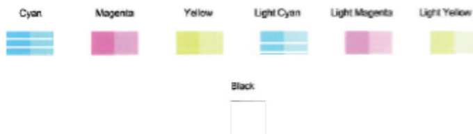
图 8-2 包含缺陷的色块示例
