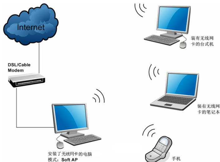
将网卡设置为点对点结构，则其他电脑可以与其进行连接，从而组建一个无线网络。但此时网卡不能再接入互联网，因此点对点结构仅适用于局域网内部的数据传输（比如有大型文件需在局域网内部进行传输或共享的情况）。
