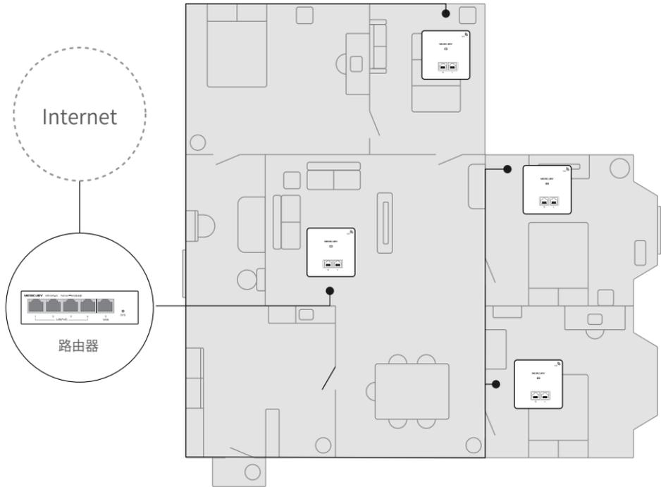
\* PoE·AC一体化路由器内置AC（无线控制器）和4口标准PoE供电功能，可统一管理MERCURY AP产品并为其供电，简化家庭无线组网复杂度。产品尺寸小巧，可部署于家庭信息箱/弱电箱。
