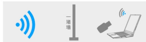
② 迷你无线网卡：穿1堵墙后，信号衰减较大。
