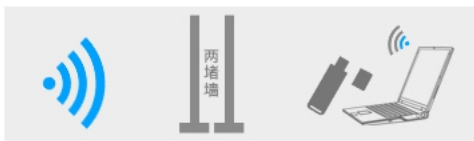
③ U盘式无线网卡：勉强穿2堵墙，信号衰减大。
