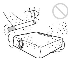
勿将本机安装在多尘或多烟雾的环境中。否则，空气滤网会被堵塞，并可能导致本机故障或损坏。灰尘会阻挡空气透过滤网，从而可能导致投影机内部温度升高。请定期清洁空气滤网。
